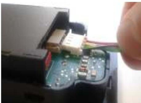
Sfilare i connettori avendo cura di non rovinare i componenti elettronici montati sulla scheda elettronica.
