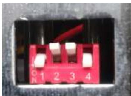
Quando si deve **sostituire una o più schede elettroniche** della serratura, del telaio o della mostrina interna occorre spostare le leve 1 e 4 in ON.
